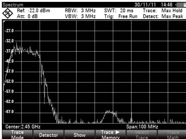
4. ábra: A mérési helyen lévő IWLAN ill. egyéb WLAN hozzáférési pontok jele
