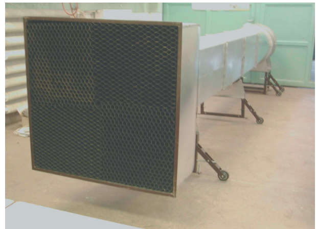
8. ábra Vízszintes szélcsatorna fényképe
