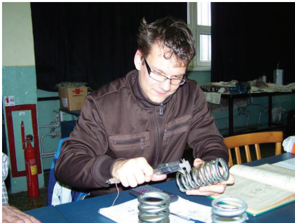
Rugó geometriai méreteinek meghatározása
