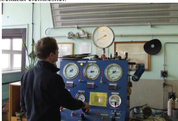
Nyitónyomás vizsgálat Biztonsági szerelvény laboratóriumban
