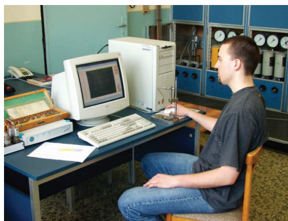
Elmozdulás mérő kalibrálása a Biztonsági szerelvény laboratóriumban
