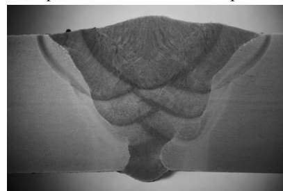
7. ábra. Az I. hegesztési próbáról készült makrofelvétel, 2% HNO 3
