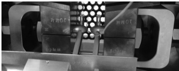
5. ábra. Egy melegsakító próbatest befogása és a próbatest a vizsgálat után.
