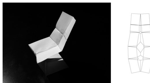
3. ábra: Gyártáshoz alakított teríték és papírmmodellje
