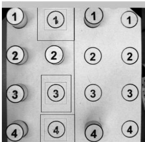
5. ábra. A paletta képe. A bal oldali két oszlop a műanyag munkadarabok helye, a jobb az alumíniumoké (jelölve a szabad műanyag pozíciók)
