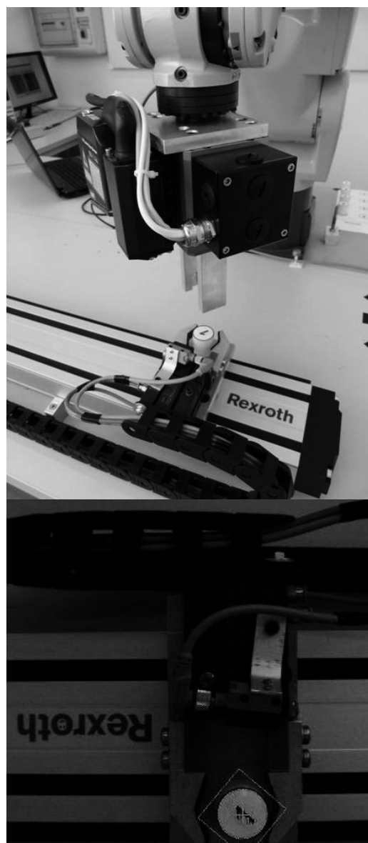
4. ábra. A munkadarab kódjának és orientációjának meghatározása (alul a kamerakép a felismert munkadarabbal)
