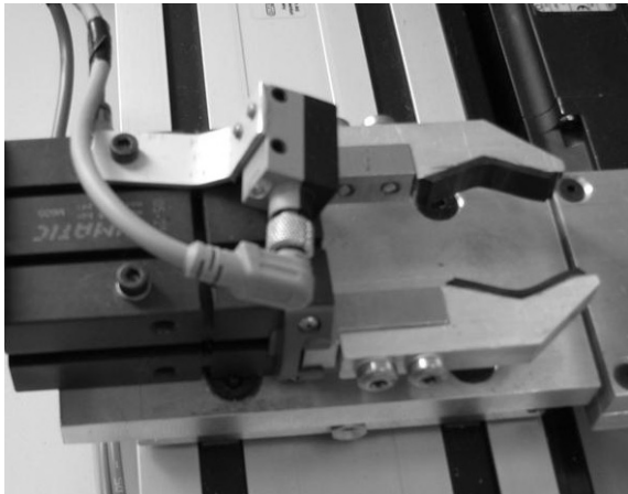
8. ábra. Optikai érzékelő elhelyezése a szánon lévő megfogón
