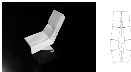
3. ábra: Gyártáshoz alakított teríték és papírmoddellje
