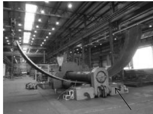
1. ábra. A nagyteljesítményű hengerítő berendezés hengerítés közben
