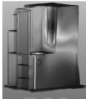
8. ábra. Az eredeti állvány elmozdulás mezője
