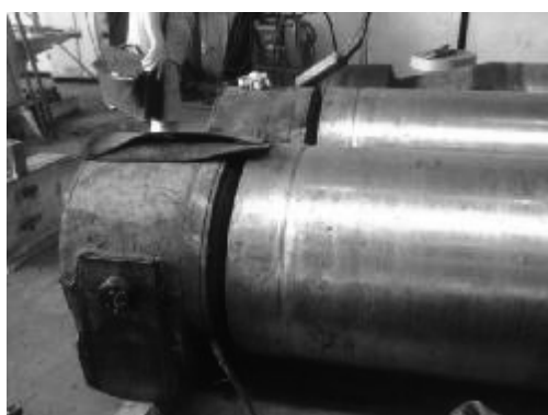
4. ábra. A hajtott henger csapágyháza
