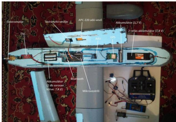
2.3. ábra: Beépített elektronika és megvalósított elrendezés
