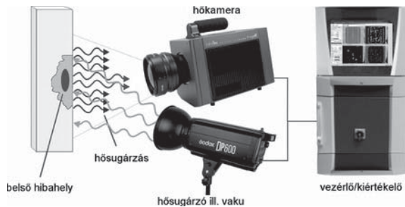
2. ábra: a rávilágításos eljárás elrendezése
