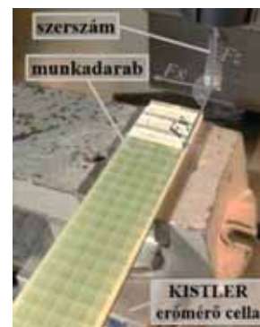
3. ábra Forgácsolási kísérlet elrendezése
