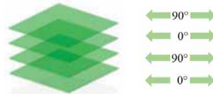
2. ábra Rétegek szálrendezése a munkadarabban
