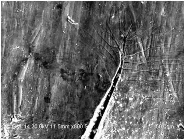
5. ábra Pásztázó elektronmikroszkópos felvétel egy jellemző mikrorepedési képről, amorf fémüveg szalag vízszintes vágását követően.
