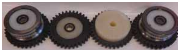
6. ábra A tárcsák elkészült hajtáslánca
