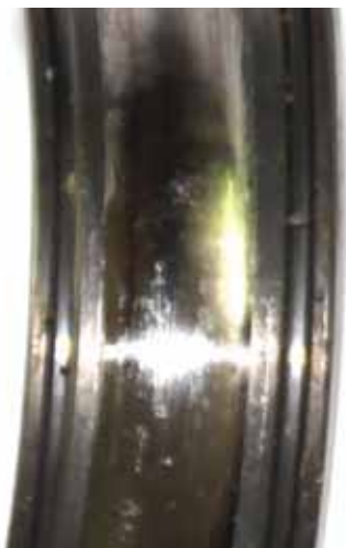
2. ábra. A mesterségesen létrehozott pontszerű meghibásodás
