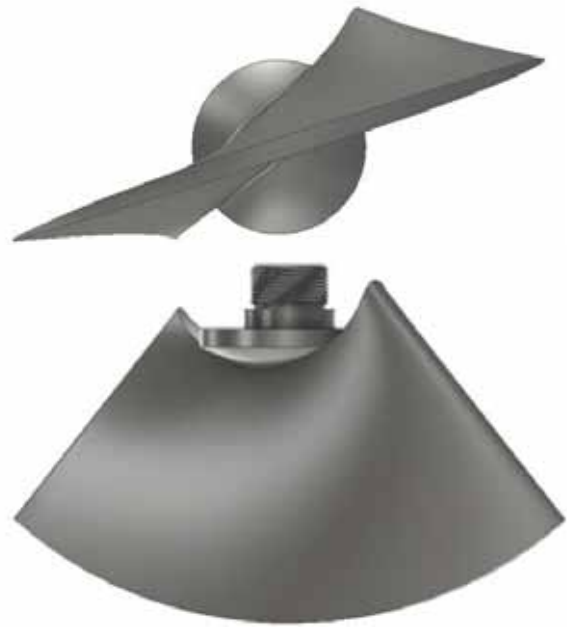
2. ábra. A G162 jelű szivattyú állítható járókerék komplett lapát 3D geometriai modell két nézeti képe
