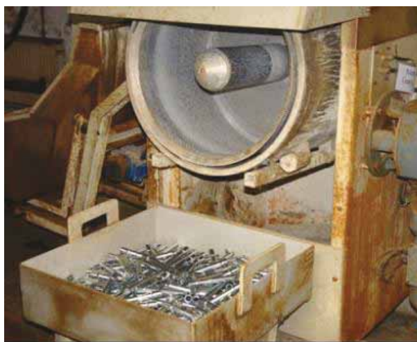
2. ábra Festett acél gyártóeszköz korrodálódott felülete ipari környezetben
