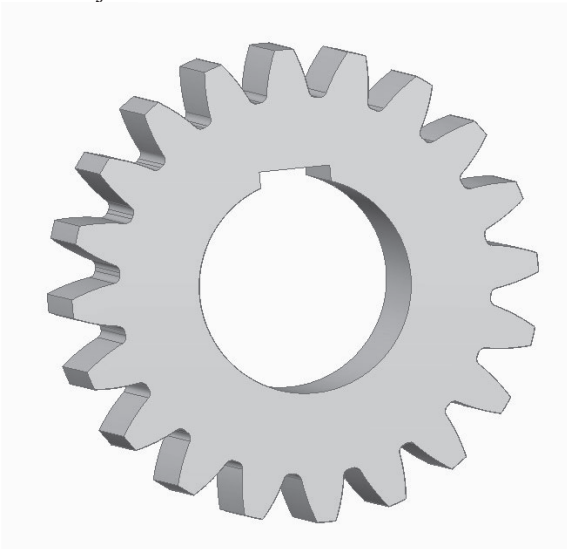
4. ábra Az Inventor által készített fogaskerék
