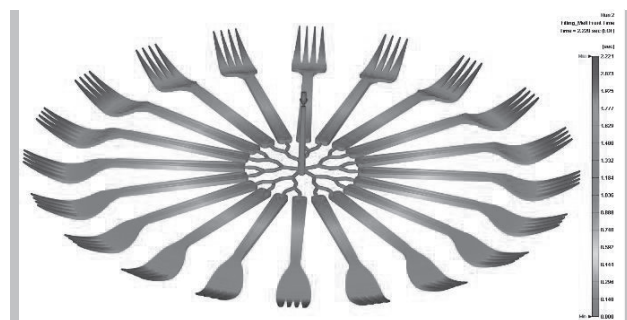
2. ábra. 20 fészkes elrendezés villa fröccsöntés szimulációjának esetére
