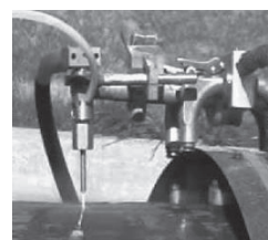
11. ábra. Zinser hordozható lemezzalag pályás abrazív csővágógép [24]
