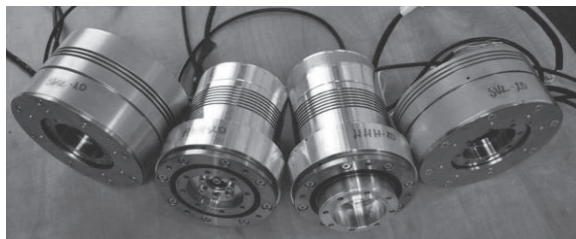
2. ábra: Kísérleti hengeres- és síkkerekes hullámhajtásrendszerek
