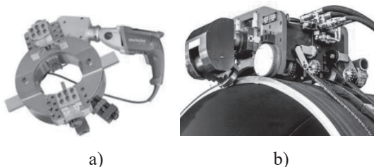
4. ábra Csővágó és élkiképző berendezések a) Metabo fűrőpisztollyal hajtott berendezés [11], b) MILLGRIP a funkciónak megfelelően tárcsamarával (vágás) és ujjmaróval (gyökölt peremkiképzés) is felszerelhető [13]
