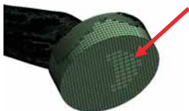
6. ábra A kritikus hálósűrűséget meghaladó méret esetén kialakuló eltérő kiterjedésű cellák a dinamikus áramlási vizsgálat szempontjából "mozgó" felületen
