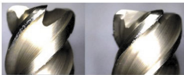
8. ábra Új- és felújított szerszámok adaptív stratégiával történt marás után [14]
