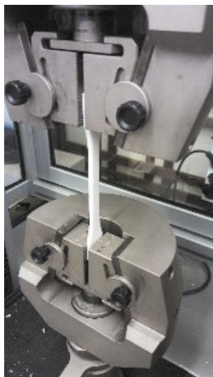
7. ábra Galdabini Quasar 100 szakító gép (saját forrás)
