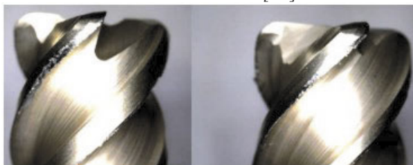
9. ábra Új- és felújított szerszámok körkörös stratégiával történt marás után [14]
