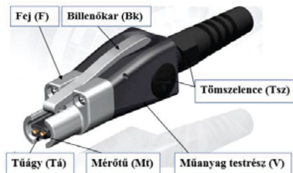
2. ábra. A diagnosztikai csatlakozók általános felépítése
