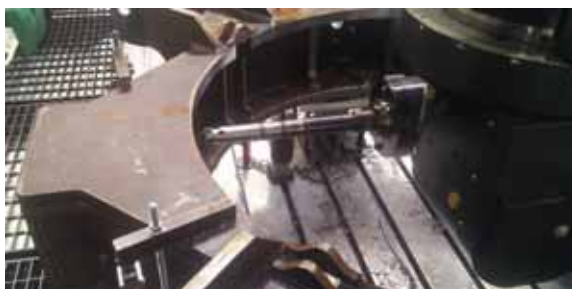
4. ábra. Az előgyártmány megmunkálása hosszú szerszámmal, megvezetés nélkül.
