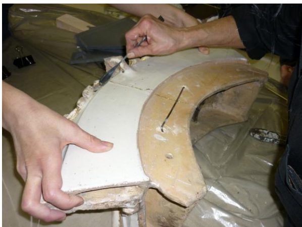
13. ábra: Egy összetört elem ragasztása ún. kályhás kapcsolás segítségével
