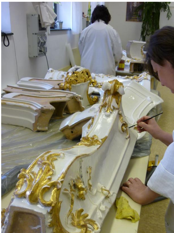
20. ábra: A hidegkréta alap egyenletes felvitele ecsettel
