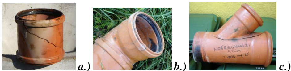
2.2.2.9 ábra: Hálózatokból kibontott meghibásodott elemek
