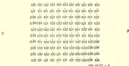
8. ábra. A mért és a számított potenciálkülönbségek hányadosa potenciál-térképezésnél (PM) kétréteges féltér felszínén A és B tápelektroda mellett (Szarka, 1980)
