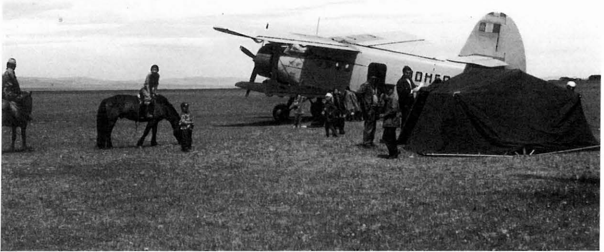
A graviméteres bázishálózat mérése az észlelősátorban (repülőgépes és lovas közreműködéssel)
