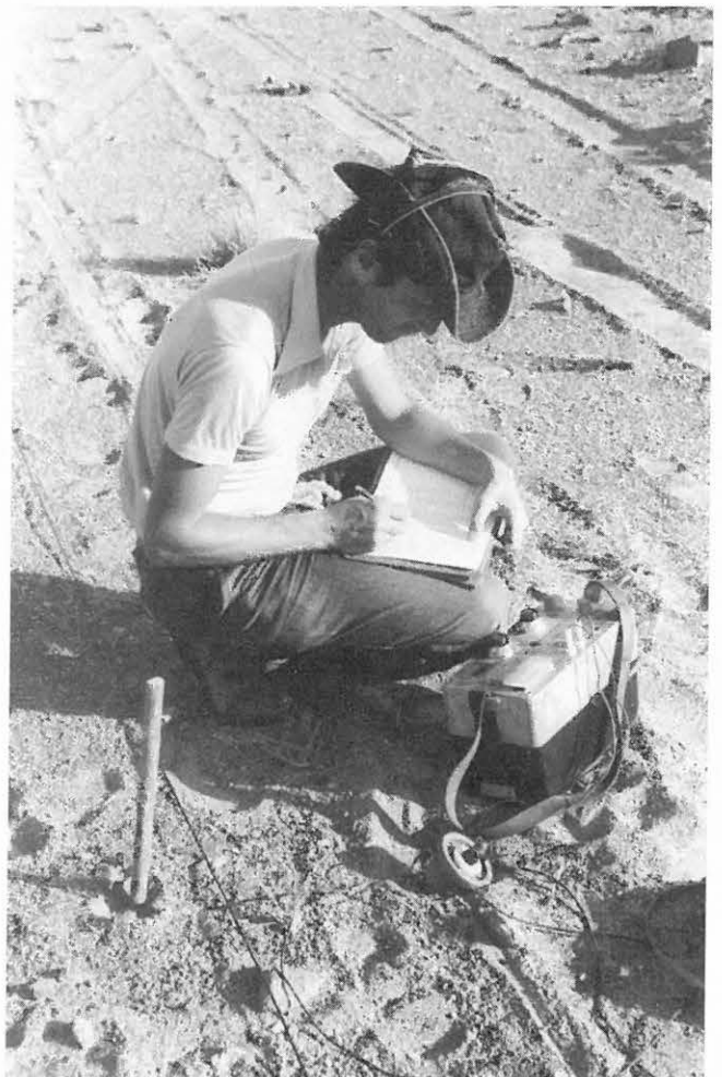
LUKÁCS József gerjesztett polarizáció mérése közben a Suten nevű mérési területen. A Geofizikai Intézetben készült Diapir-E típusú műszer a mostoha körülmények között is jól vizsgázott
