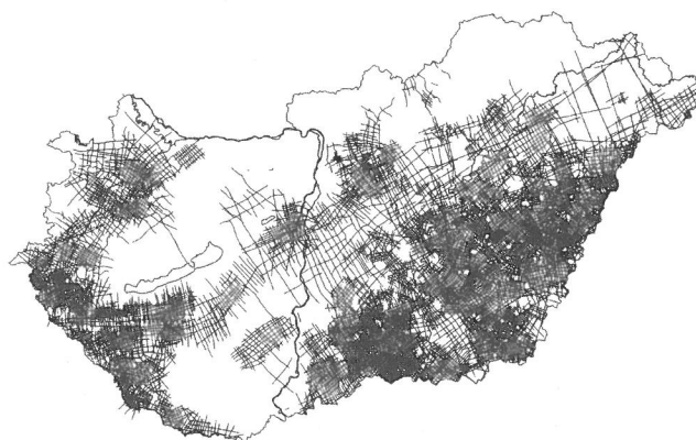
14. ábra. A GKÜ–GKV–GES és az ELGI által 1971 és 2000 között mért magyarországi 2-D-s, digitálisan feldolgozott szeizmikus szelvényeinek nyomvonalai. A vonalak együttes hossza kétszer bőven körbeérné az Egyenlítőt! (a MOL engedélyével)
