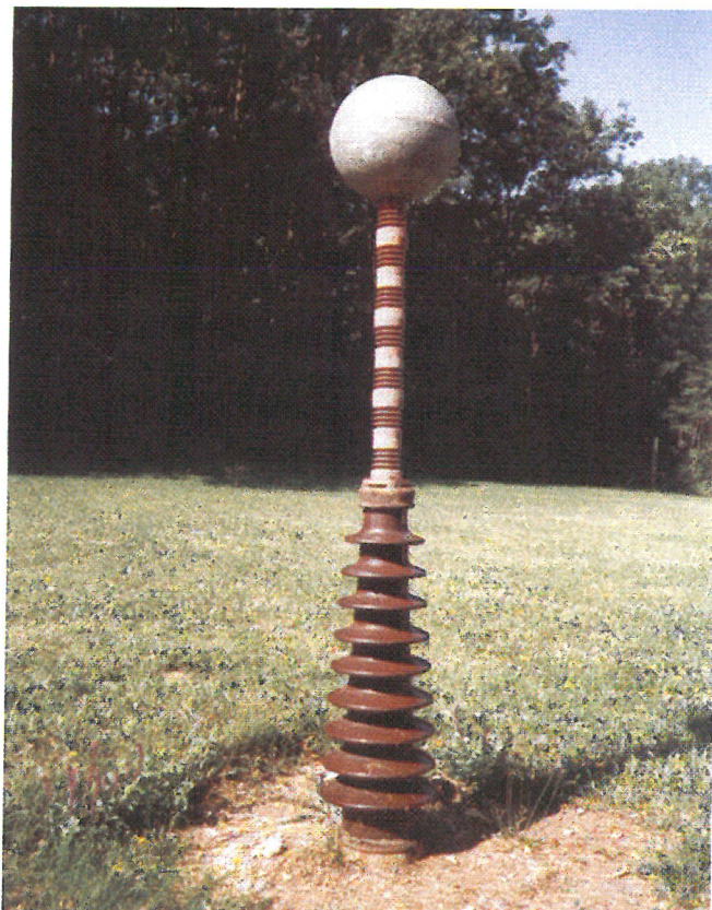
2. ábra. Gömbantenna a Schumann-rezonanciák vertikális elektromos komponensének a mérésére a Széchenyi István Geofizikai Observatóriumban [SÁTORI et al. 1996]
