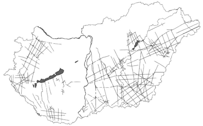
2. ábra. A kőolajipar által 1952 és 1961 között készített első országos regionális reflexiós szeizmikus vonalhálózat, kiegészítve az ugyanez időszak alatt lőtt refrakciós vonalakkal [A Kőolajipari ... 1962 nyomán]
