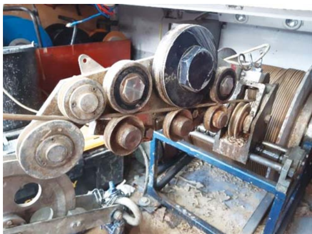
10. ábra. Korszerű (nagy pontosságú) mérőkerék-kialakítás
