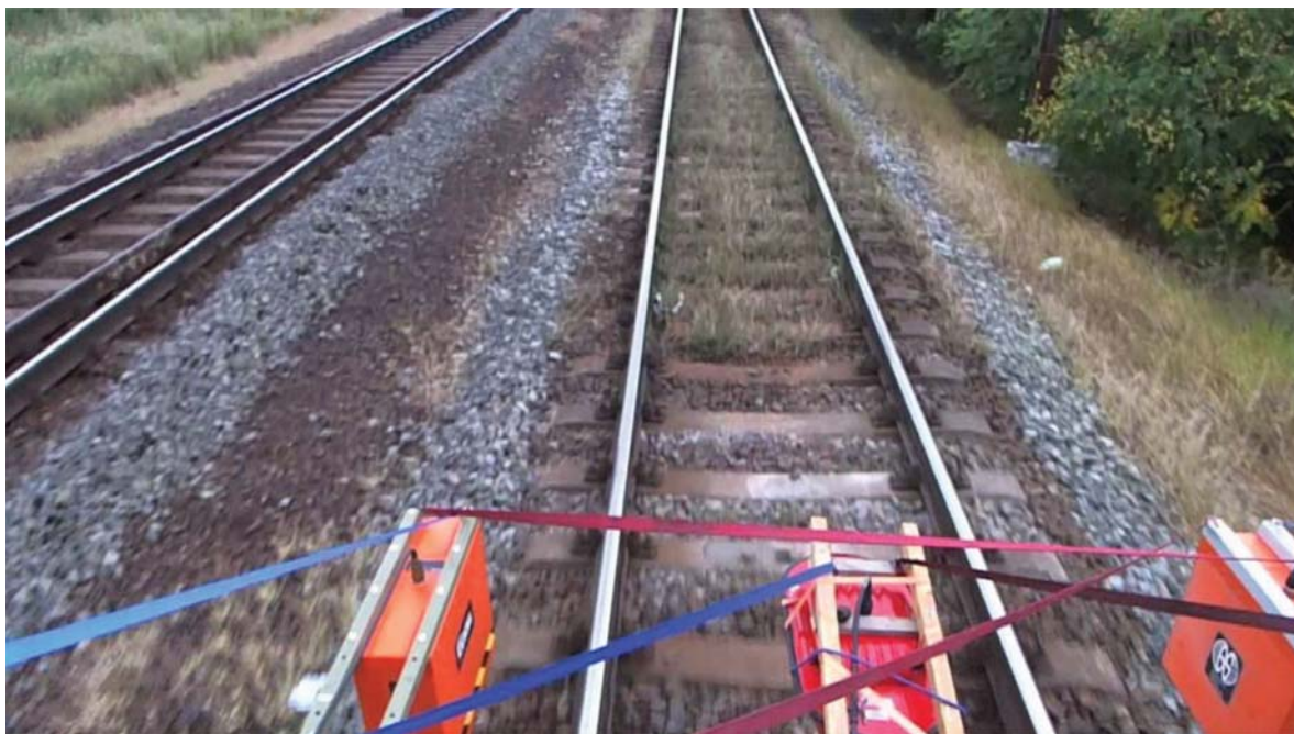
1. ábra Radarmérés vasúti pályatesten két 1 GHz-es tölcsérantennával a széleken, míg a sínek között egy levegőben vitt 350 MHz-es antenna kombinációjával, a lehető legnagyobb adatgyűjtési sebesség eléréséhez többcsatornás GSSI SIR-30 rendszer alkalmazásával
