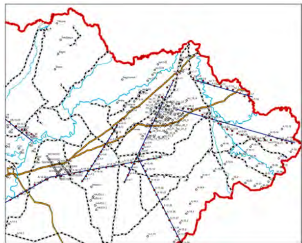
6. ábra Magnetotellurikus mérési pontok a Nyírségi területen a vasúti hálózattal és a főbb olajvezetékekkel. MT szelvények (sötétkék) – inverzióra alkalmas szelvénymenti mérési pontok piros szimbólummal
