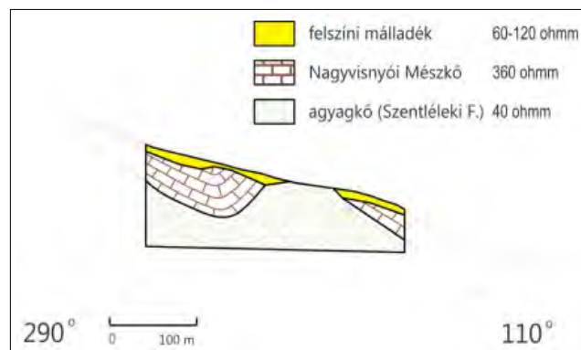
17. ábra A 7-8-as szelvény alatti földtani metszet a Köpüs-forrás környékén, GBR-adó
