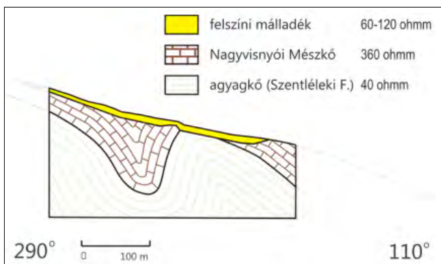
16. ábra A 6-os szelvény alatti földtani metszet a Köpüs-forrás környékén, GBR-adó
