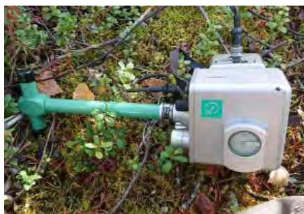
1. kép | A Geonics EM16 alaplámpa (balra) fajlagosellenállás-mérő EM16R opcióval (jobbra) Picture 1 | Geonics EM16 instrument (left) with resistivity unit EM16R (right)
