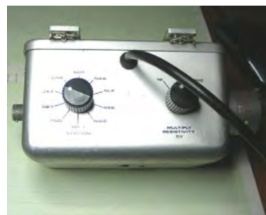
1. kép | A Geonics EM16 alaplámpa (balra) fajlagosellenállás-mérő EM16R opcióval (jobbra) Picture 1 | Geonics EM16 instrument (left) with resistivity unit EM16R (right)
