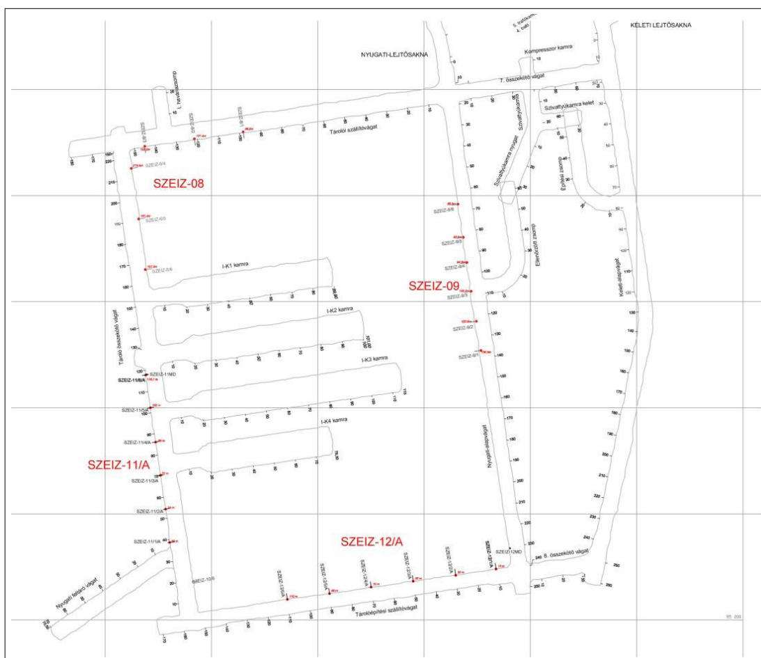
1. ábra A szeizmoakusztikus monitoring rendszerek telepítési helyszínrajza
