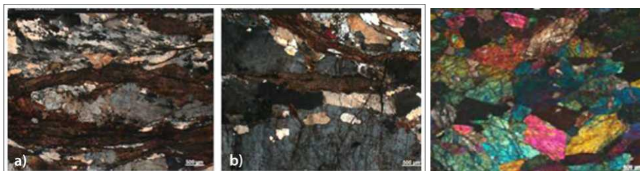
4. ábra Amfibolit hornblende ásványi elegyrészei (+N, 500 millimikron, Sz-176)
