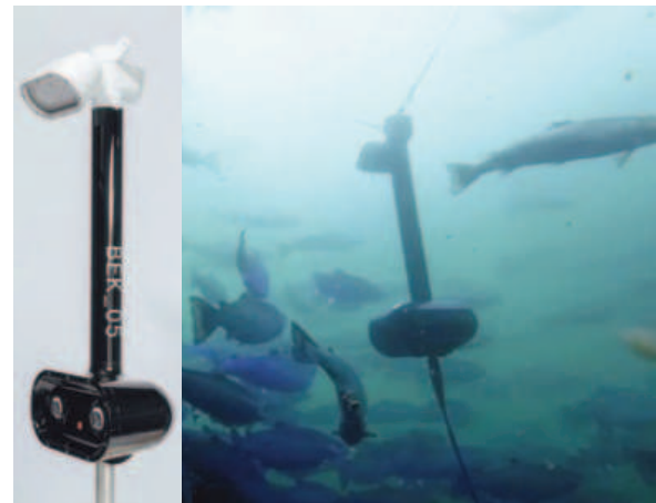
A Tidal képalkotó platformja, amely lámpákat, több kamerát és egyéb érzékelőket tartalmaz, a vizekben mozogva gyűjti az adatokat
