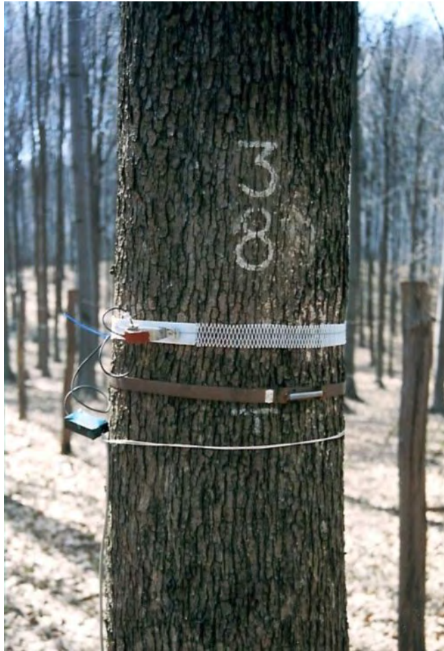
1. ábra A kerületmérés mérőeszközei (felső – automata, alsó – kézi)
