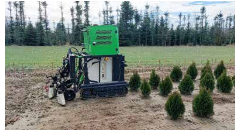
1. ábra. A sorközpermetezővel szerelt haRiBOT V2 önjáró robot
