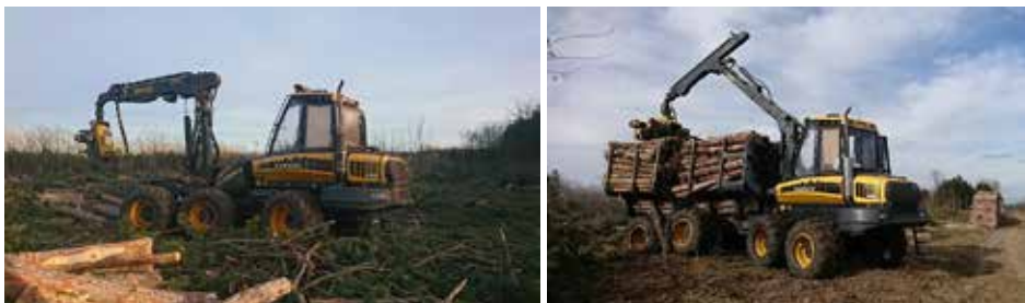
2. ábra: Ponsse Beaver harvester és Ponsse Wisent forvarder (Forrás: saját kép)
