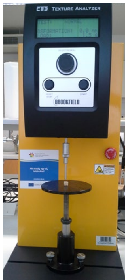
1. ábra: Nyomófejvel ellátott textúra vizsgáló működés közben (Forrás: saját felvétel)
