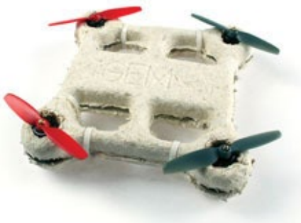
Ecovative gombafonalakból készített elbomló drone váz természetvédelmi területeken való használatra
