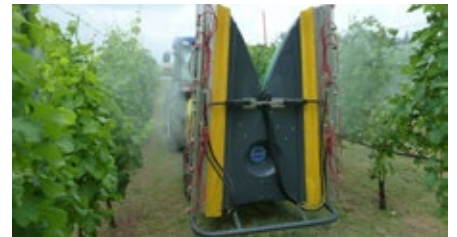
12. kép: A lombfal magasságának és sűrűségének megfelelően beállított permetezőgép
