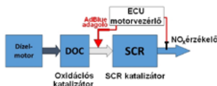
3. Ábra. Első generációs SCR-katalizátor
