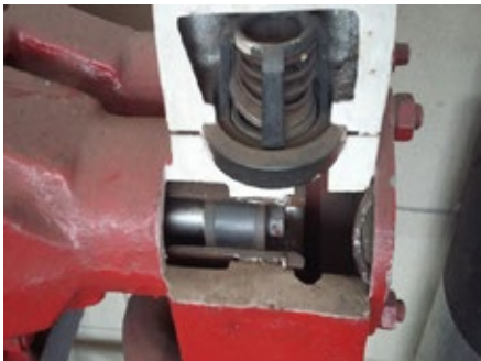
2. ábra. A dugattyússzivattyú légüsttel (a) és a gumidugattyú (b) (Forrás: saját felvétel)
