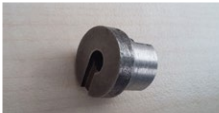
7. ábra. Szóróíven található szórófejek (a) és a cirkulációs szórófej (b) (Forrás: saját felvétel)
