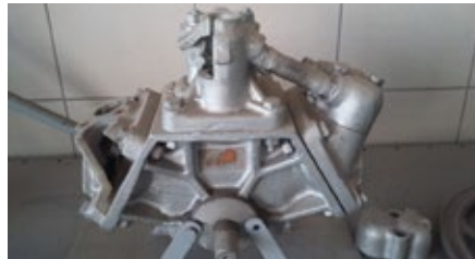
3. ábra. Membránszivattyú metszet (Forrás: saját felvétel)
