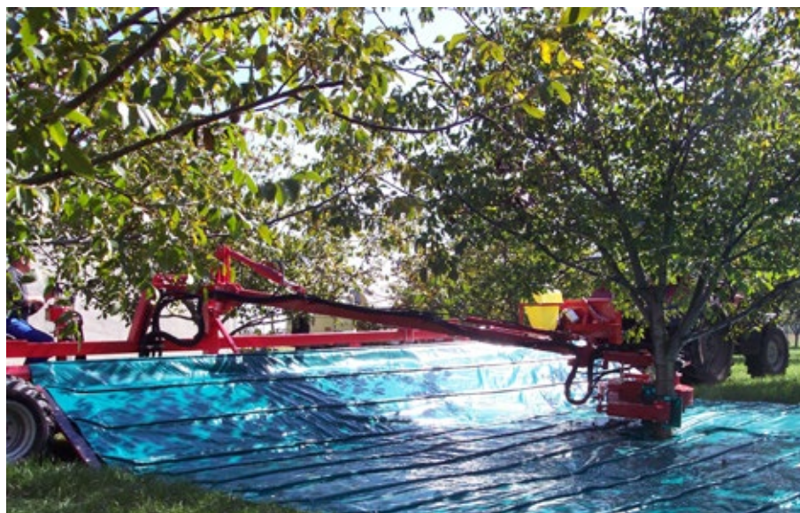
6. ábra. Felfogóernyővel ellátott LIPCO típusú lökőrudas rázó-gép betakarítás közben (Forrás: Bartifarm Kft.)
