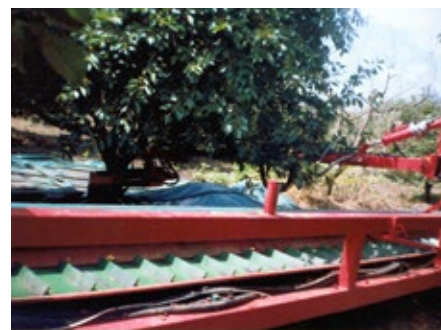
7. ábra. Keresztbordás hevederszalaggal ellátott LIPCO típusú vontatott rázó-gép (Forrás: saját felvétel)
