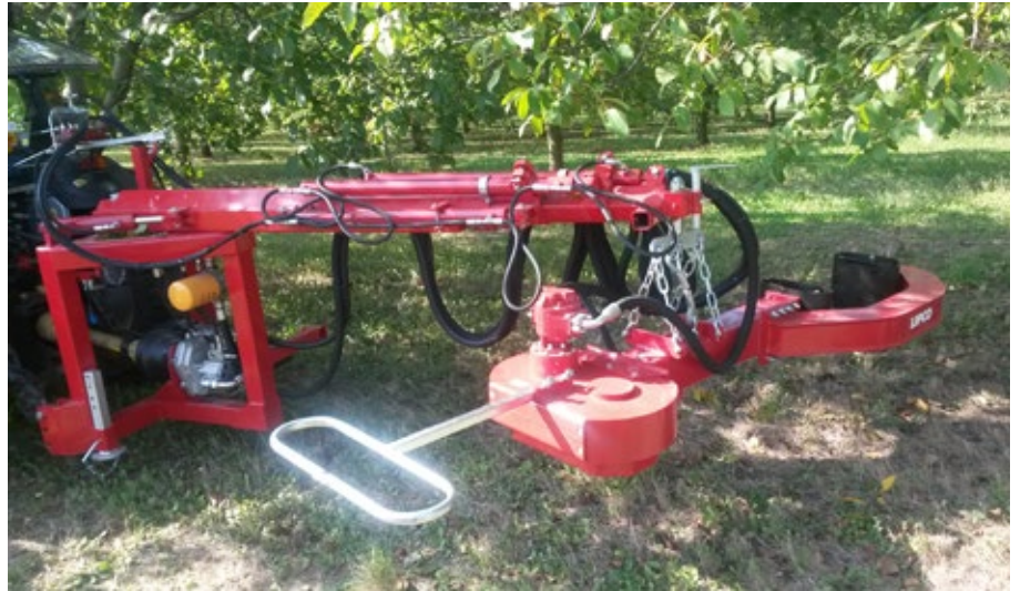
4. ábra. A lökőrúd „C” alakú megfogóval (Forrás: Bartifarm Kft.)
