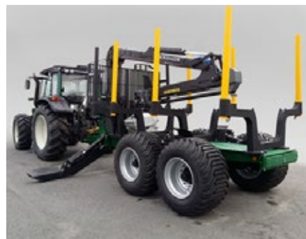
Utánfutós traktor (kihordó szerelvény) (Fotó: www.kronos.fi)
