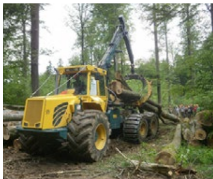
Szorítószámolyos vonszóval végzett hosszúfás közelítés (Fotó: Horváth A. L.)
