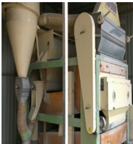
4. ábra. Lengőrostás univerzális magtisztító berendezés (Forrás: saját felvétel)
