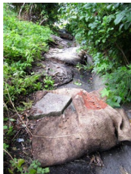
3. ábra: Egy mikofiltrációs megoldás: Vázszonzsákok, benne laskagomba szubsztrátum szűri ki és bontja le az elcsorgó vízben levő motorolajat, mielőtt az a csatornarendszerbe és onnan a környező folyókba kerülhetne.
