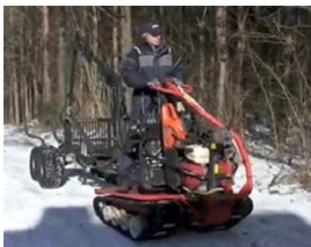
Vasló darus rönkszállító pótkocsival
