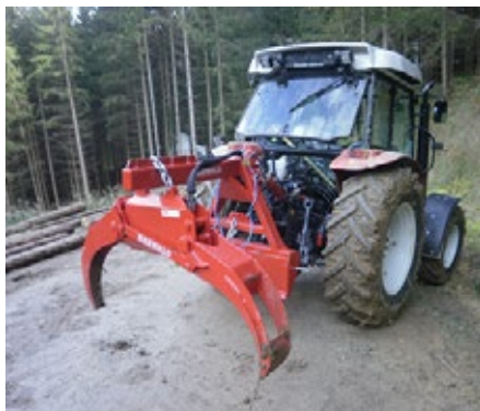
Univerzális traktor alapú markolós vonszoló (Fotó: Horváth A. L.)
