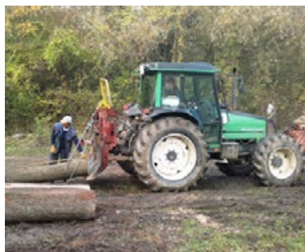
Hosszúfás közelítés univerzális traktor alapú csörlős vonszolóval (Fotó: Horváth A. L.)
