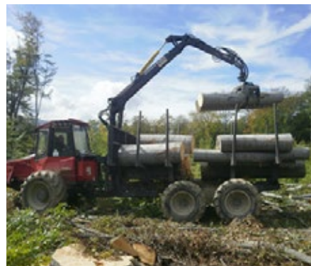
Rövidfás közelítés forvarderrel (Fotó: Horváth A. L.)
