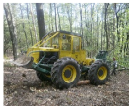
Csőrlős vonszoló (Fotó: Horváth A. L.)
