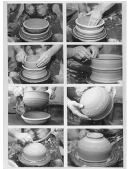
3. kép. Domború díszes tál készítésének folyamata formatál segítségével (Kivitelezések: Tóth Gergely fazekasmester, fotók: Oszkó Zsuzsa)
