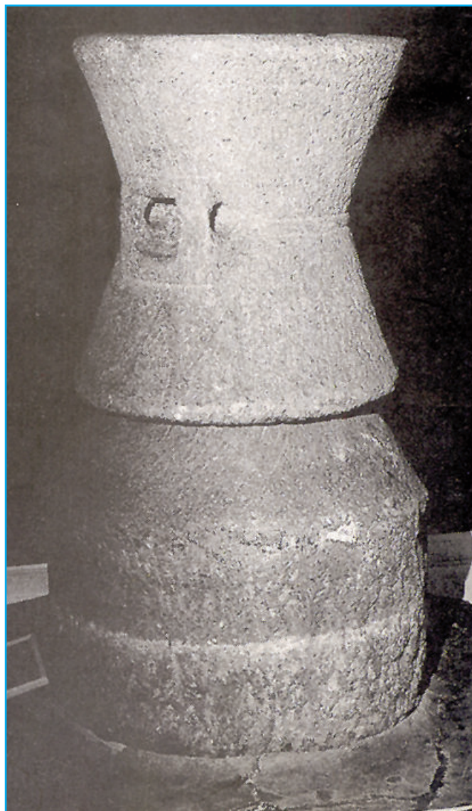
A szárazság idején használaton kívüli malom, alján gabonaszemekkel. A durva szemű gabonát a tetején beöntötték, beleillesztettek a tetején levő lyukba egy botot, és egy ember körbejárt a malom körül, forgatva a botot. A finomra őrölt gabonaszemből kipergett a liszt a malom alján
