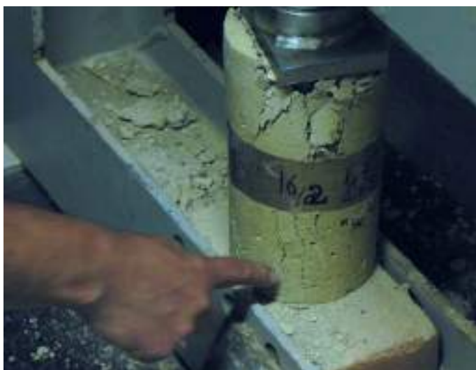
3. ábra Vertfal anyagú próbatest nyomószilárdsági vizsgálata [fotó: Bihari Ádám]
