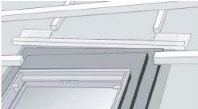
7. ábra Példák az tetősíklablak feletti vízelenítés kialakítására merev vízvezető csatornával [13]
